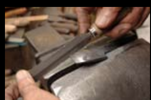
↑目打ちと言っても日本の革細工に使われてきた「菱目」やヨーロッパで馬具などに使われてきた「ヨーロッパ目」など種類がある。オーダーした職人が求める「目」と革を傷つけず切れ込み鋭さはこのヤスリがけひとつで生み出される
