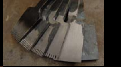
←ちなみにカバンなど数多く作られるものはこうした抜き型を使うのが主流。岩田屋さんも本来はこの製作が本業なので興味のある業者の方は問い合わせを。もちろん目打ちのオーダーも受け付けてくれる。(岩田屋工具店 TEL03-3872-0325 www.tctv.ne.jp/iwataya)
