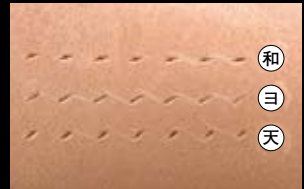
↑上が目がひし形で角度の浅い日本流の「菱目」、中が角度がある目が線状の「ヨーロッパ目打ち」。穴の開け方で縫い目のかかり方や耐久性も変わってくるため、実は重要な部分なのだ。天神ワークスは両方のいいところ取りをしたオリジナルの目打ち（一番下）を特注で製作して使用
