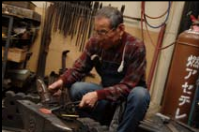
●1000度を超え熱くなった鉄を、槌で叩くだけでも簡単に形にしてゆく。実際にはしっかりと芯を捉えて叩くだけでも熟練を要するという。鉄は叩かれることに不純物が火花を散らして飛び、強い鋼になる。職人の道具は職人が作り上げるのだ
